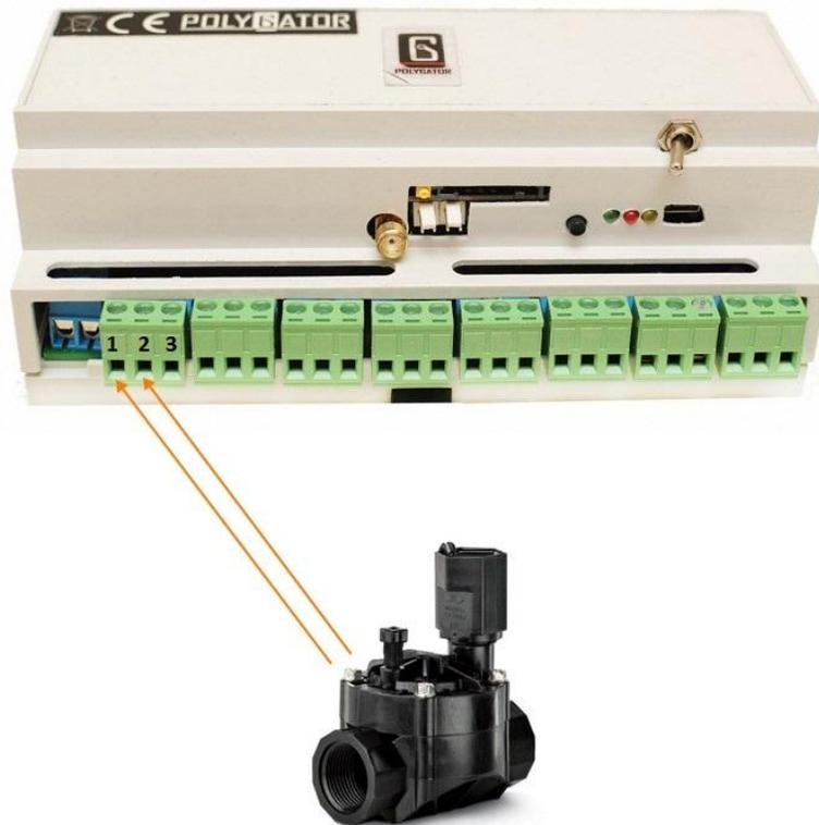
Размыкаемые клеммники позволяют сначала соединить провода, идущие к нагрузкам, с внешней частью клеммника, а затем вставить ее прямо в работающее устройство без опасения удара током, или менять нагрузки «по горячему». Наружу выведен разъем micro USB.
